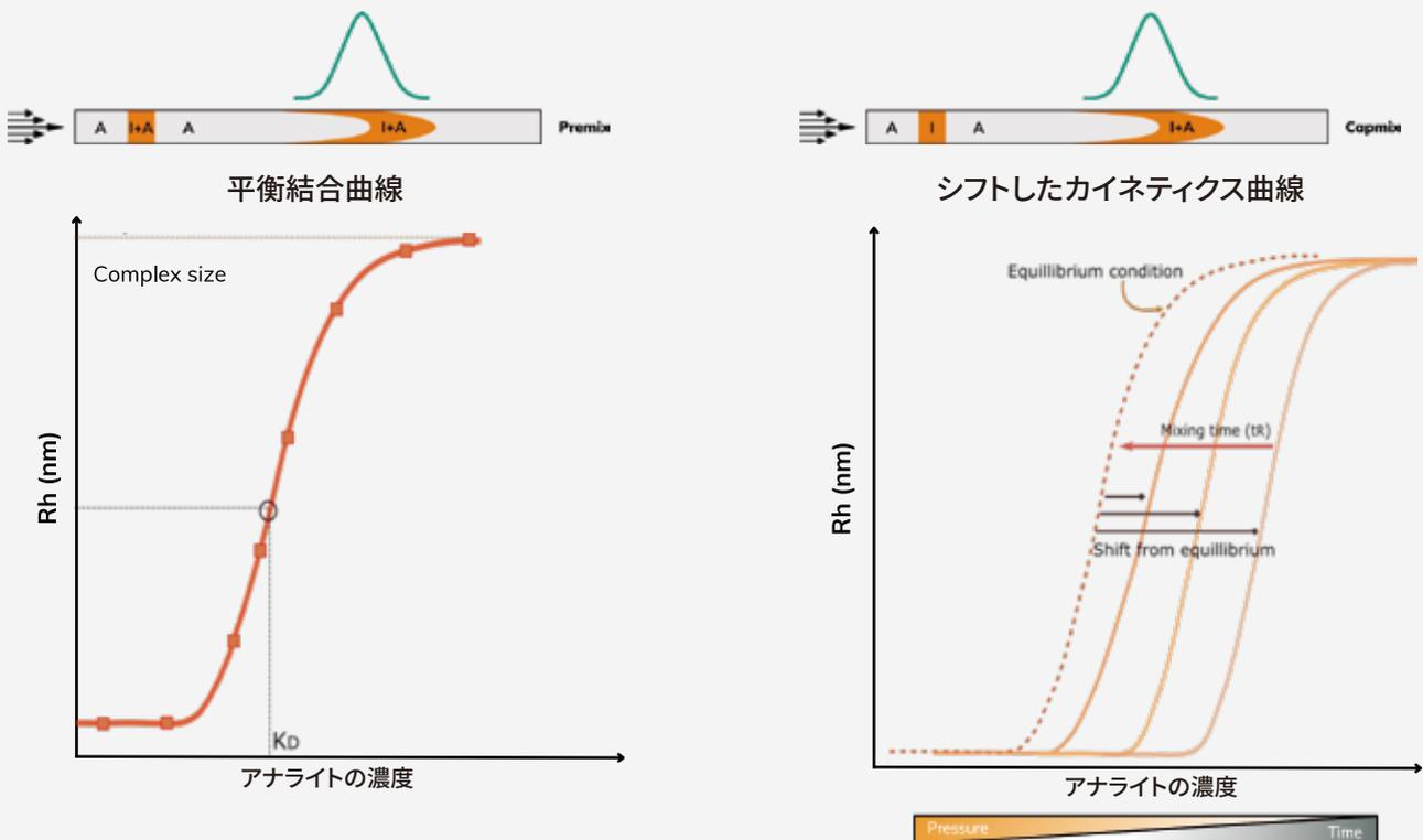
図. FIDAを用いた平衡結合曲線および速度論的結合曲線。上の図はキャピラリー内の混合原理を示し、下の図は平衡結合曲線とシフトされた反応速度曲線を示しています。平衡親和性測定用にすでに調製されたサンプルは、反応速度論的結合曲線の測定に再利用できるため、サンプルの消費を最小限に抑えることができます。
