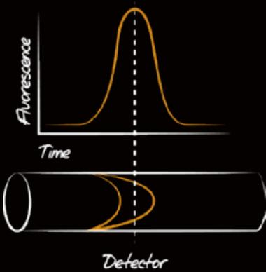
FIDAは層流中の粒子の蛍光を測定し、時間経過に伴う分散を解析することで、対象粒子の流体力学的半径を計算することができます。使用される2つの基本原理は、テイラー分散と層流です。
