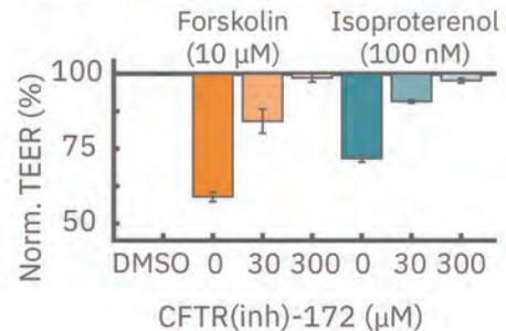
A: CytoView Zプレート上にCalu-3細胞を播種し、イソプレテレンール(100 nM、水色)、フォルスコリン (10 μM、オレンジ色) をそれぞれ投与したところ、TEERは急激に減少した。続いてCFTR(inh)-172(胞性線維症膜コンダクタンス制御因子(CFTR)抑制剤)を30μM、300μMの異なる濃度で投与したところ、TEERのリカバリーが見られ、そのリカバリー速度はCFTR(inh)-172の濃度に依存した (薄色線ほど高濃度を示す)。
