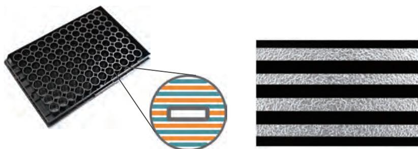
CytoView-Z 96プレート。各 wellの底面に平面電極が埋め込まれている(左)。
