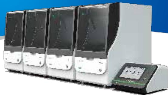
遺伝子/細胞治療の分野の急速な拡大により、高品質なプラスミドの効率的な抽出が必要とされています。シリカメンブレンやイオン交換カラムを用いる従来の方法では、特にMidi~Maxiスケールのプラスミド抽出において、一度に抽出できる数量に限りがあり、また、時間と労力を必要とする手動操作が必要となります。AmMag™ Quatroは、1.2 gのバクテリア細胞由来のペレットに対応できる**Maxiスケールの全自動プラスミドDNA抽出装置**です。集菌後のペレットから約120分~150分で1 mg (注) のプラスミドDNAを抽出可能です。全ての試薬・消耗品が集約されたキットを使用し、複数の遠心分離のステップを省略させることで、プロセス全体がスピードアップし、お客様の時間、労力、費用を節約することができます。本体は、**1台あたり6サンプル同時に処理できるモジュールを並列して最大4台までフレキシブルに増設**でき、お客様の研究、環境や、実験スタイルに合わせて選択可能です。
