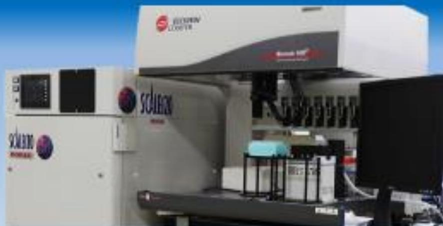
Cellkeeper™は、多様な細胞株、培養フォーマットの細胞の培地交換を自動的に行う、全自動培地交換システムです。
