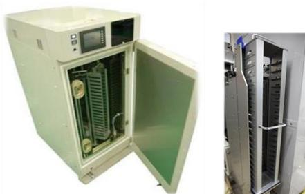
搭載のCO2インキュベーター“SCALE120”は、培養条件を厳密にコントロールしています。
